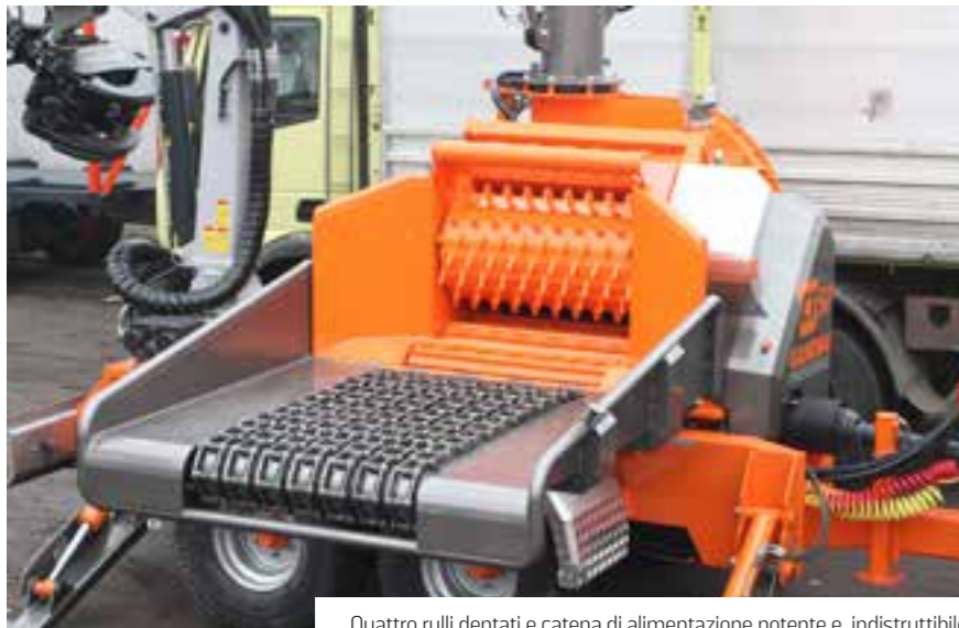
Quattro rulli dentati e catena di alimentazione potente e indistruttibile
