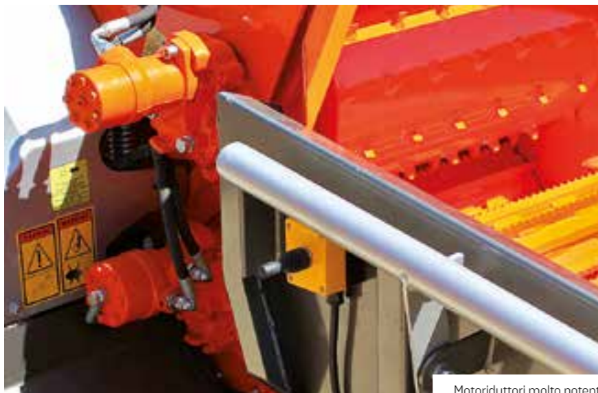
Motoriduttori molto potenti
