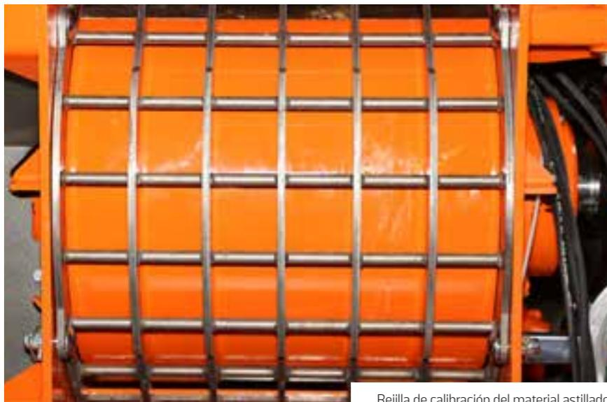
Rejilla de calibración del material astillado.
