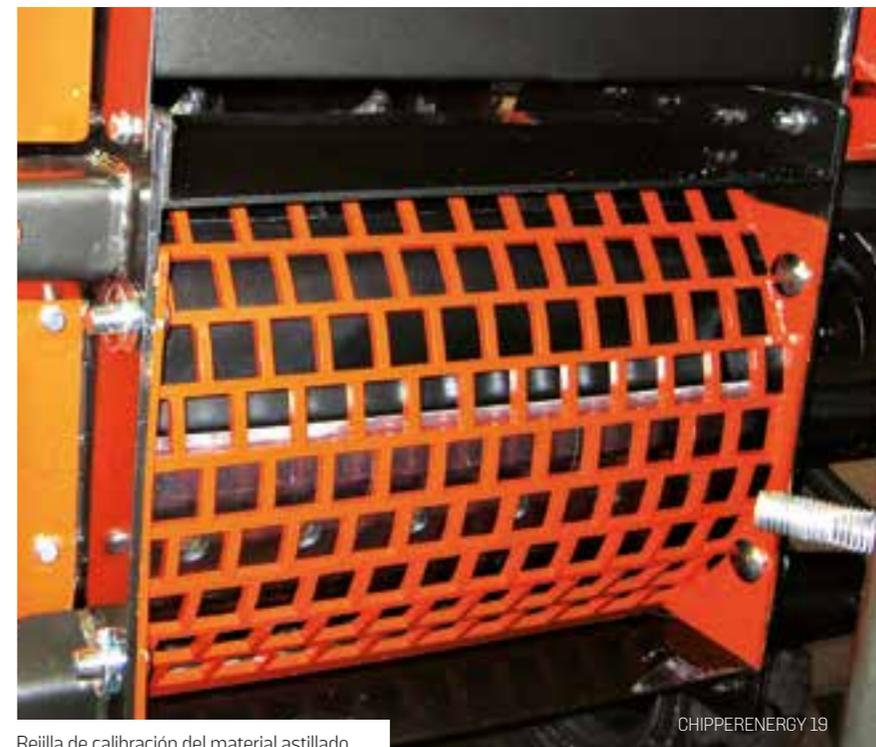
Rejilla de calibración del material astillado.
