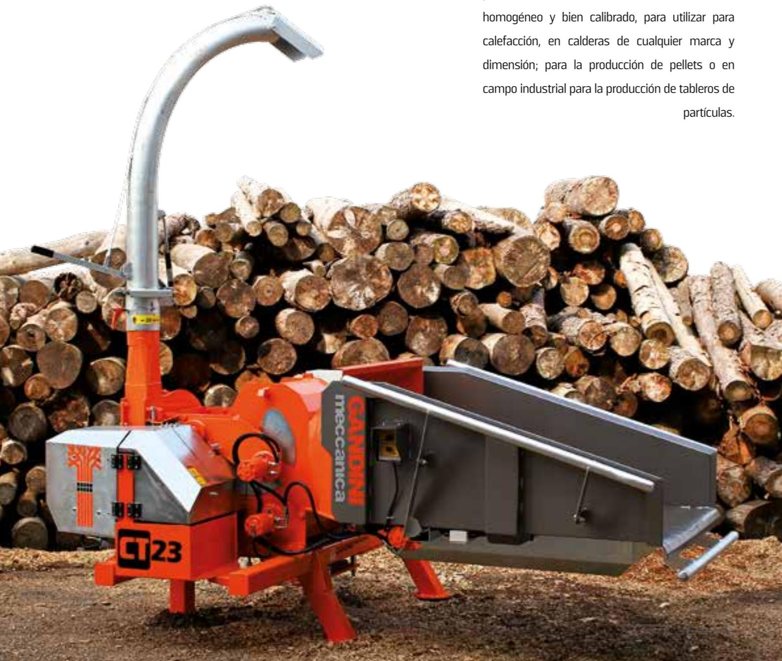
Línea de astilladoras profesionales de dimensiones medias con sistema de corte de tambor. Estudiada para obtener material astillado de alta calidad, homogéneo y bien calibrado, para utilizar para calefacción, en calderas de cualquier marca y dimensión; para la producción de pellets o en campo industrial para la producción de tableros de partículas.
