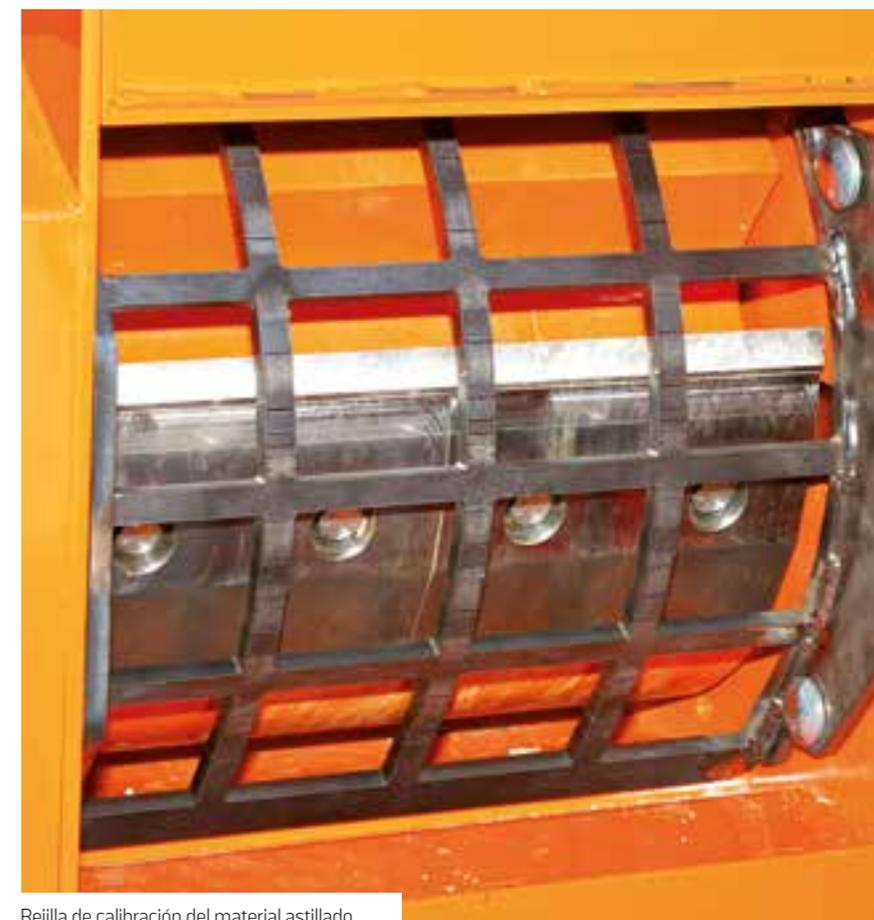
Rejilla de calibración del material astillado.
