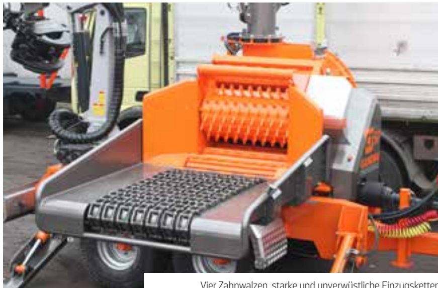
Vier Zahnwalzen, starke und unverwüstliche Einzugsketten.
