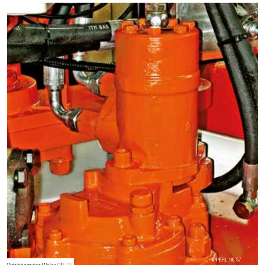
Getriebemotor Walze CH 13
