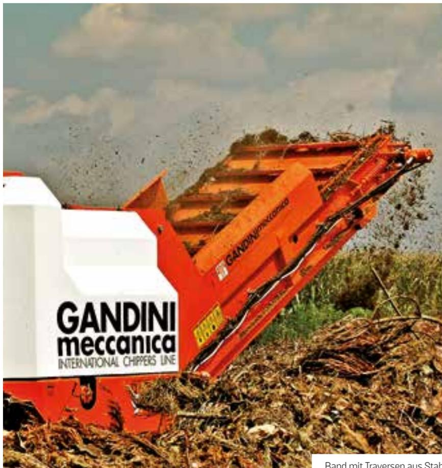
Band mit Traversen aus Stahl
